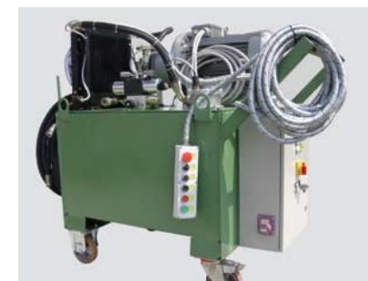
DISPONIBILE CENTRALINA IDRAULICA CAPACITÀ OLIO 200 L, CON TELECOMANDO ED INTERCOOLER PER RAFFREDDAMENTO.
